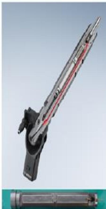
压电式喷油器的灌封
